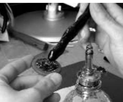
Preparación del Instrumento: El saxofón es desmontado cuidadosamente, comprobando el estado de todos los elementos que lo componen (muelles, tornillerías, fieltros, corchos...). Quitamos los corchos y limpiamos los restos de pegamentos así como revisamos el estado de las llaves. En la reparación integral, que es
