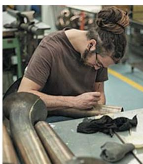
El **cuerpo** está fabricado a partir de una plancha de latón (mezcla de cobre y zinc) de 6 a 7/10 décimas de milímetro de espesor; cortado en forma de trapecio. La plancha es enrollada, soldada y estirada sobre un mandril de forma cónica. El cuerpo es
