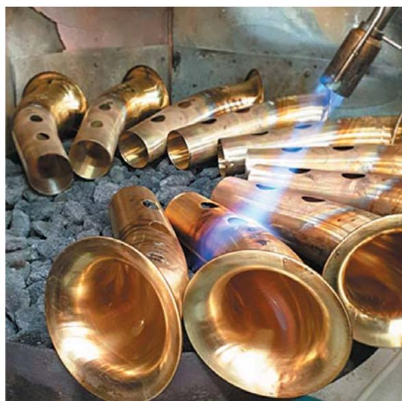
Una vez las campanas son preformadas, se ajusta y estiran en mandriles con forma con el fin de darle las cotas definitivas. El ribeteado consiste en insertar un hilo de latón en el borde superior de la campana para reforzar el espesor y permitirle vibrar. El material utilizado en este anillo puede tener una incidencia acústica. Al final del ciclo de calderería, las piezas pasan por un proceso de limpieza en la banda, pulido que permite dejar preparada la superficie.
