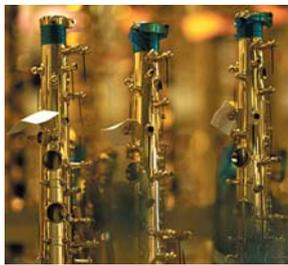
Las diferentes piezas primarias son soldadas por soldadura a la plata sobre un premontaje. Después de un riguroso control se guardan en el almacén "Subconjuntos".
